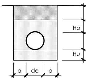
Ho : Couche de protection qui dépend du type d'engin de compactage utilisé; l'épaisseur minimale est de 30 cm.
