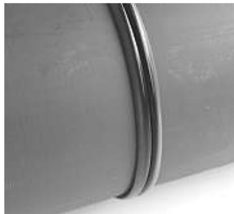
*Abb. 5.15: Hezelement-Stumpfschweissmaschine und Schweissnaht*
